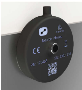
Die Antenne erhöht und mit Abstand zu festen Objekten positionieren
